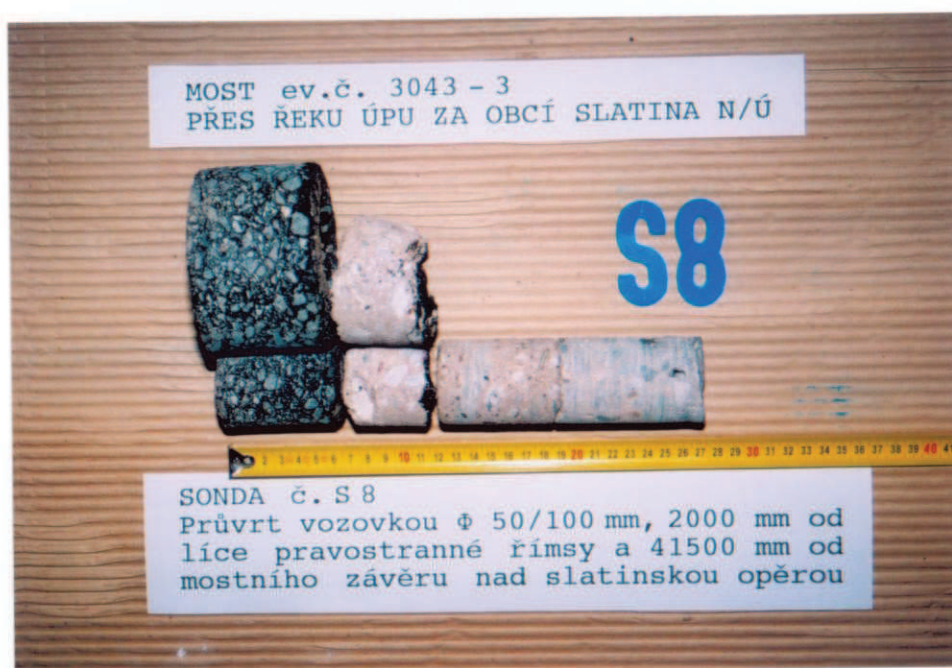
Obr.A14-28 Sonda č. S 8. Průvrt vrstvami vozovky při pravém obrubníku ve 3. poli, 41500 mm od MZ nad I. podpěrrou a 2000 mm od líce pravostranné římsy.
