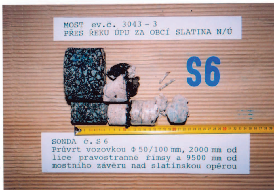
Obr.A14-26 Sonda č. S 6. Průvrt vrstvami vozovky při pravém obrubníku přibližně v polovině rozpětí 1. pole, 9500 mm od MZ nad I. podpěrou a 2000 mm od líce pravostranné římsy.
