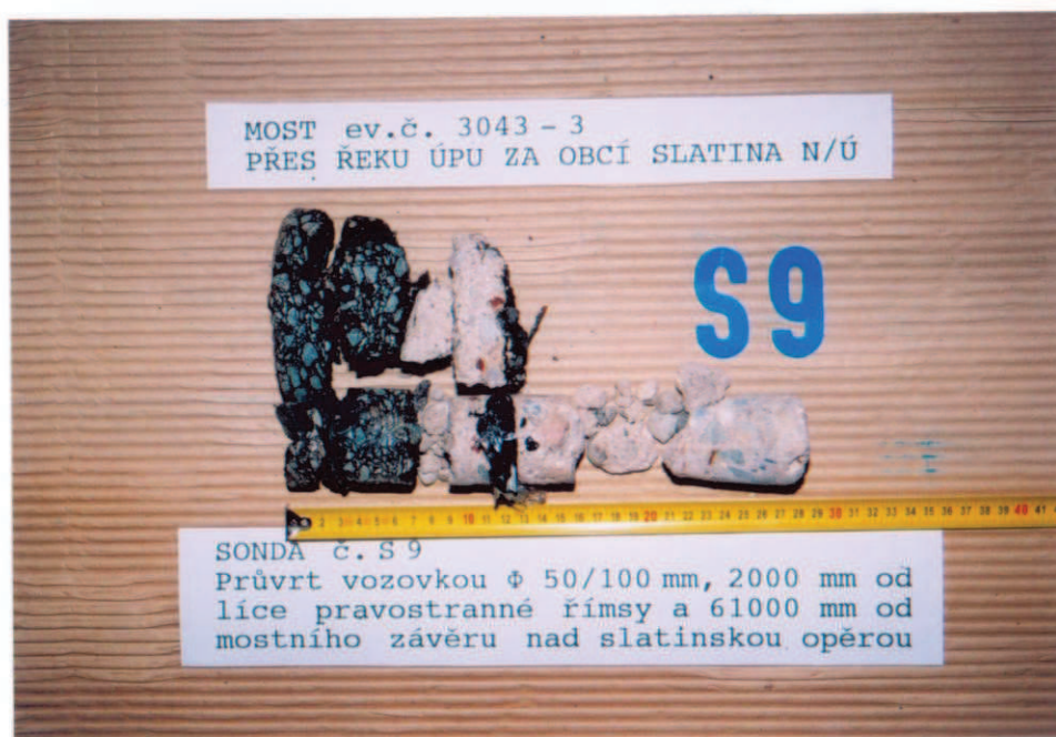
Obr.A14-29 Sonda č. S 9. Průvrt vrstvami vozovky při pravém obrubníku ve 4. poli, 61000 mm od MZ nad I. podpěrou a 2000 mm od líce pravostranné římsy.
