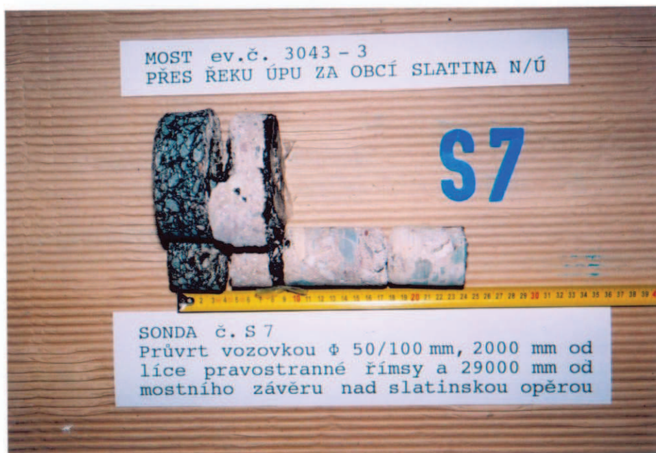
Obr. A14-27 Sonda č. S 7. Průvrt vrstvami vozovky při pravém obrubníku přibližně v polovině rozpětí 2. pole, 29000 mm od MZ nad I. podpěrrou a 2000 mm od líce pravostranné římsy.
